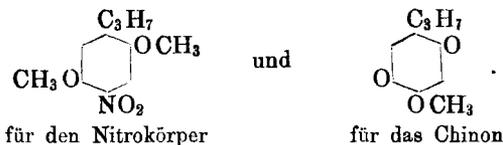
Zur Feststellung der Constitution des Nitrokörpers wurde ein Vorversuch unternommen. Es erschien uns zunächst zweckmässig, das durch Amidiren des Nitrokörpers erhaltene Propyldimethoxyamidobenzol über die Diazo- und Hydrazo-Verbindung hinweg in ein Propyldimethoxybenzol zu verwandeln.
